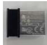
■アルコール検知器接続用USBアダプタ(Silicon Labs社製 BLED112)
